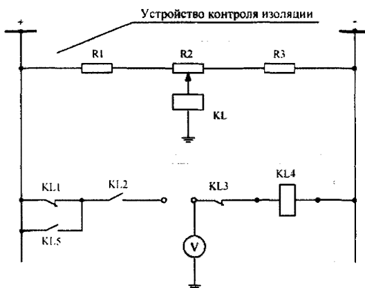
Рис. 8. Схема отыскания неисправности с помощью вольтметра
